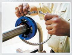
Schleifmittel aufsetzen Apply the abrasives
