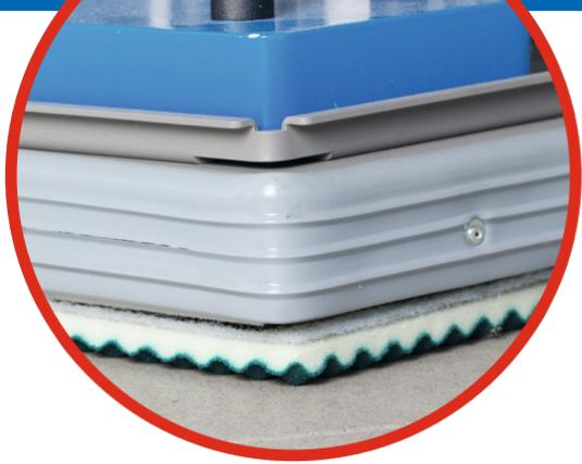
Die Absauglippe steht als Zubehörteil zum Nachrüsten für den Floor Sander zur Verfügung. Sie ist mit zwei Schrauben einfach zu montieren und verwandelt den Floor Sander so in eine Maschine, mit der auch nass gesaugt werden kann. Hierzu muss lediglich der Staubfilter und der Staubbeutel aus dem Staubsauger entfernt werden.
